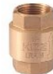
شیر یکطرفه فنری Spring Check Valve Model: KZ7782-100 Material: Brass Size: 1/2-3 inch W.P.: 1/2-1 inch 16 bar 1 1/4-2 inch 12 bar 2 1/2-3 inch 8 bar
