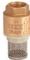
شیر یکطرفه فنری فیلتردار Inline Check Foot Valve Model: KZ7782-100 Material: Brass Size: 1/2-2 inch W.P.: 1/2-1 inch 16 bar 1 1/4-2 inch 12 bar
