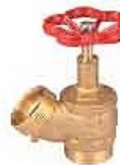
شیر آتش‌نشان Fire Fighting Valve Model: KIZZFFV-015 Material: Brass Size: 1 1/2 inch W.P.: 15 bar
